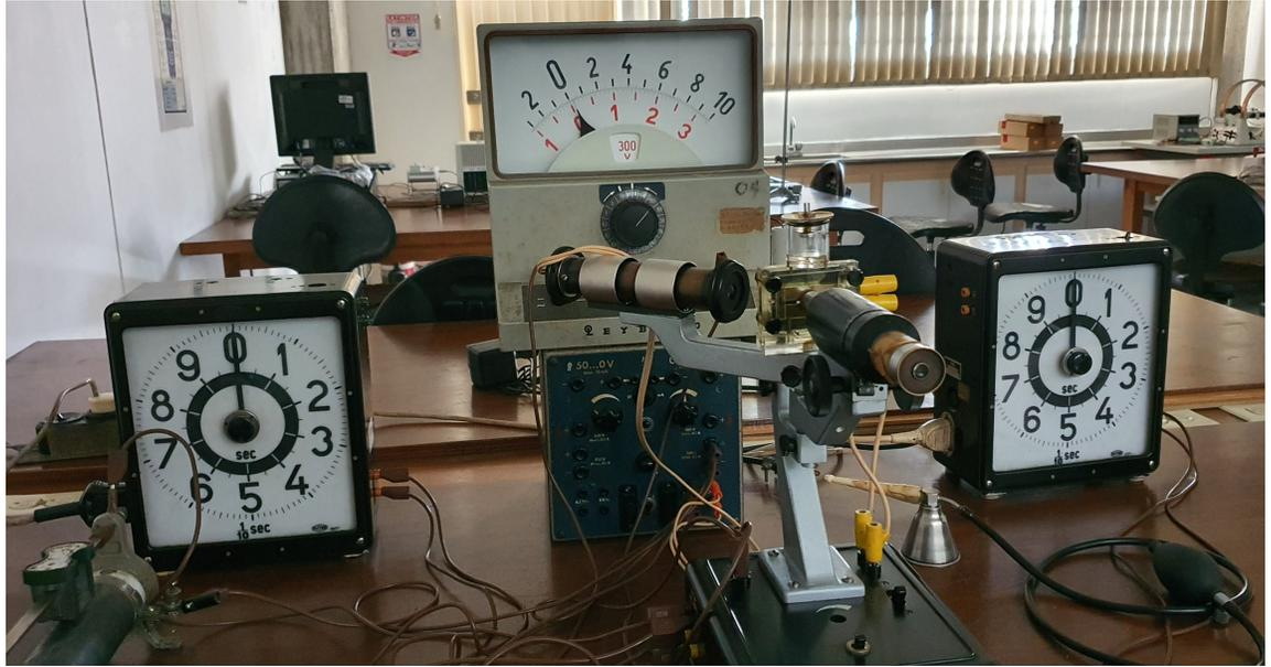
Figura 5.2: Equipo para el experimento de Millikan
