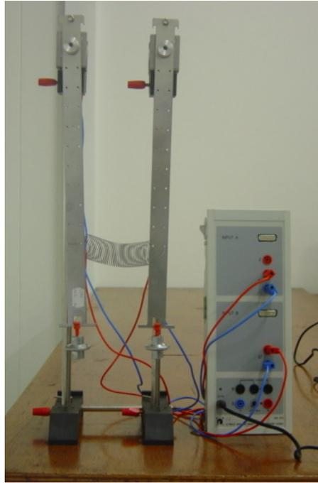
Figura 2.2: Montaje de péndulos acoplados.
