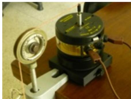
(b) Vibrador mecánico
