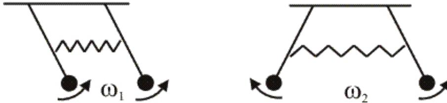
Figura 2.4: Péndulos acoplados oscilando en fase (izquierda) y contrafase (derecha).
