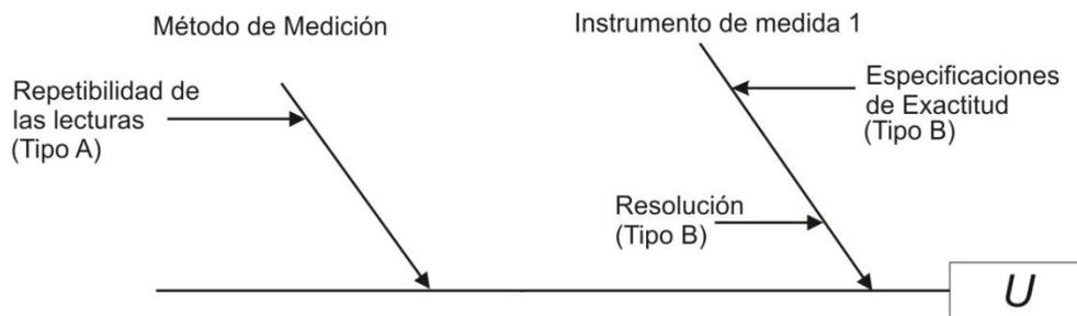
**Figura 7. Fuentes de incertidumbre involucradas en el proceso de medición.**
