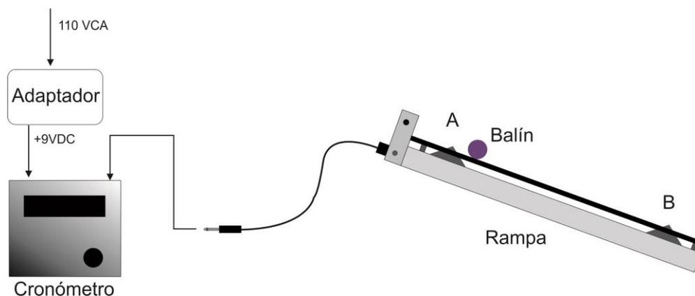
Figura 8. Diagrama que ilustra el montaje del equipo para medir los tiempos.
