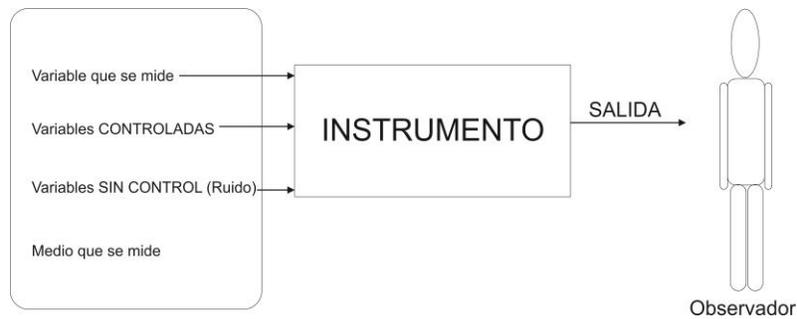
**Figura 1. Diagrama esquemático de un sistema de medida.**
