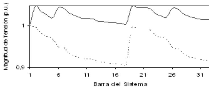
Figura 4.30. Perfil de tensión para el nivel de carga media
