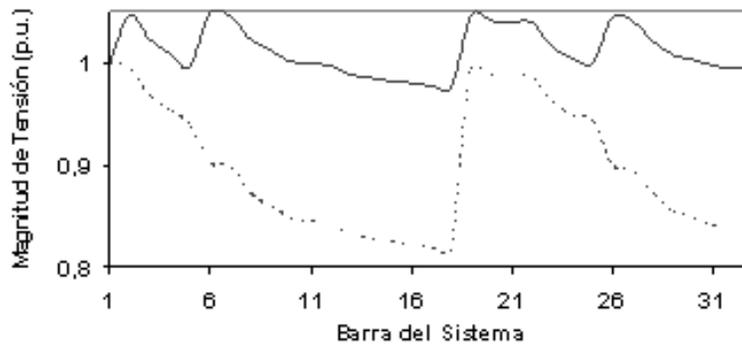
Figura 4.29. Perfil de tensión para el nivel de carga máxima
