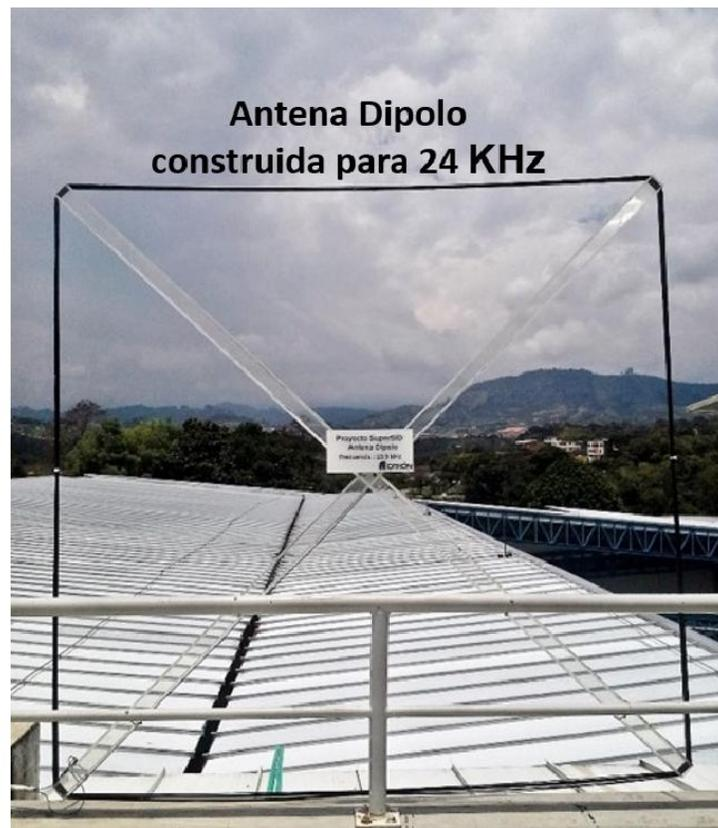
Figura 2. Antena dipolo rectangular del sistema para el monitoreo del clima espacial del Observatorio Astronómico UTP (Jaramillo, A. E.; Galvis, H. D.; Quintero, 2017).
