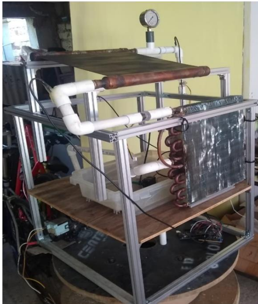
Figura 3. Banco de pruebas construido basado en las norma NTC 5434
