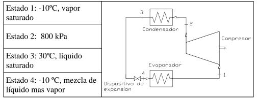
Si el flujo de masa es 0.025 kg/s y la eficiencia adiabática del compresor es 70% entonces:
