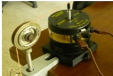
Figura 3.5: Vibrador mecánico.
