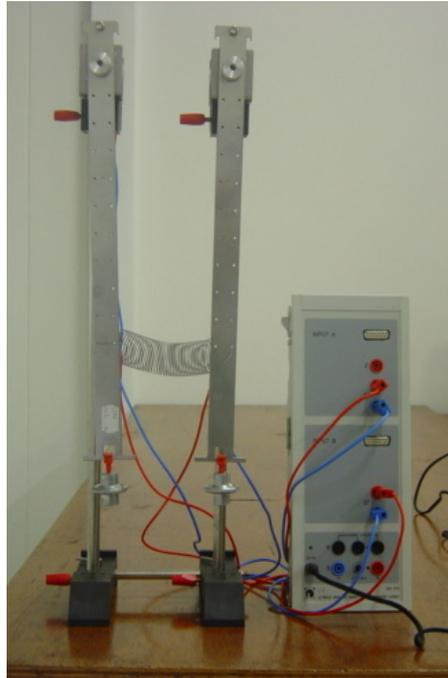
Figura 2.2: Montaje de péndulos acoplados.
