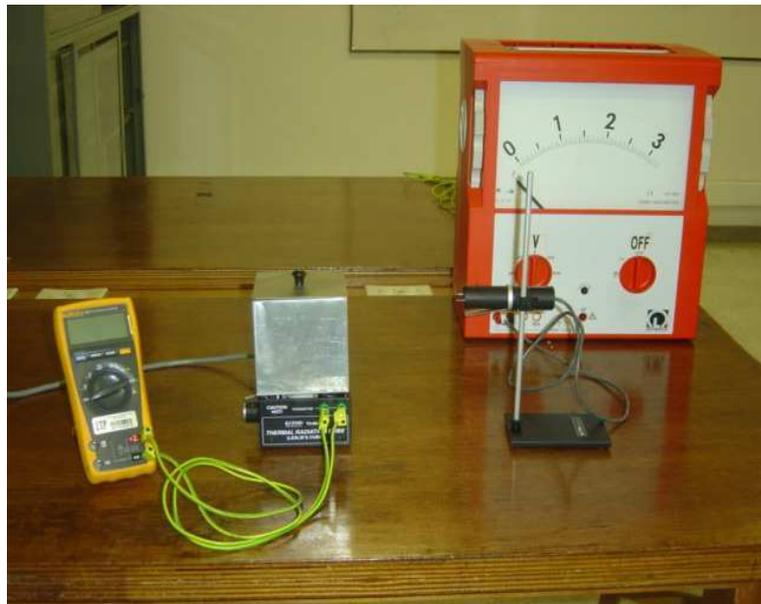
Figura 2.8: Montaje experimental para la introducción a la radiación térmica.
