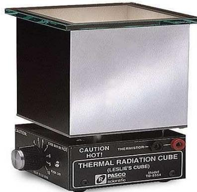
Figura 2.2: Cubo de radiación térmica PASCO TD-8554A
