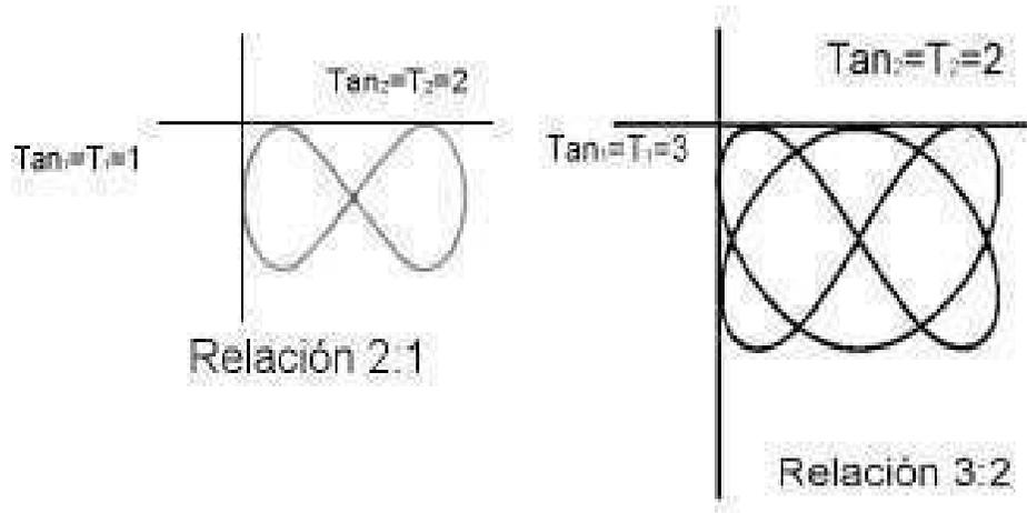
Figura 3.3: Superposición de dos M.A.S. con diferentes frecuencias.
