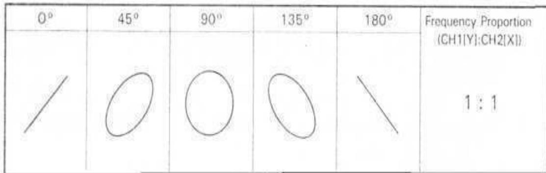
Figura 3.2: Superposición de dos M.A.S. para diferentes desfases.
