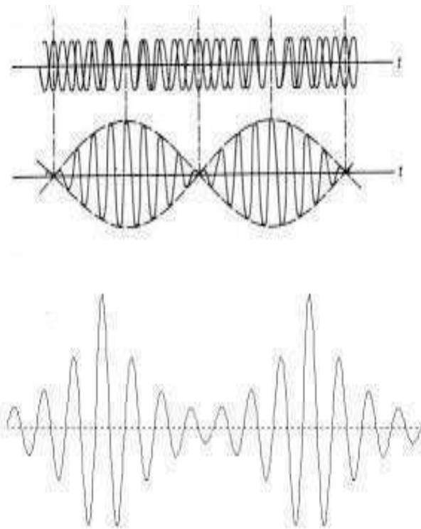
Figura 3.4: Pulsaciones producidas por la superposición de dos ondas de frecuencias muy cercanas
