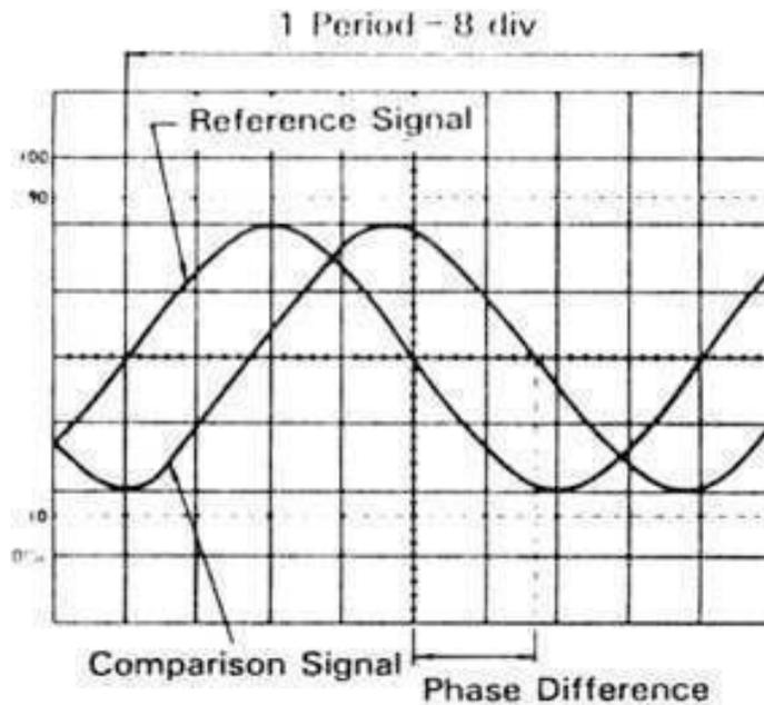
Figura 3.1: Diferencia de fase entre dos señales sinusoidales.
