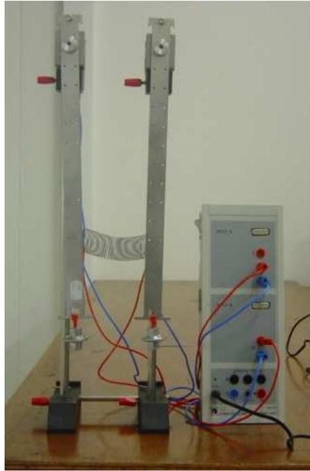
Figura 2.2: Montaje de péndulos acoplados.
